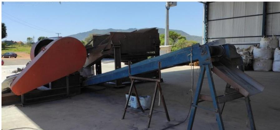
**Figura 20.** Equipamento Britador 3 (novo) com esteira
