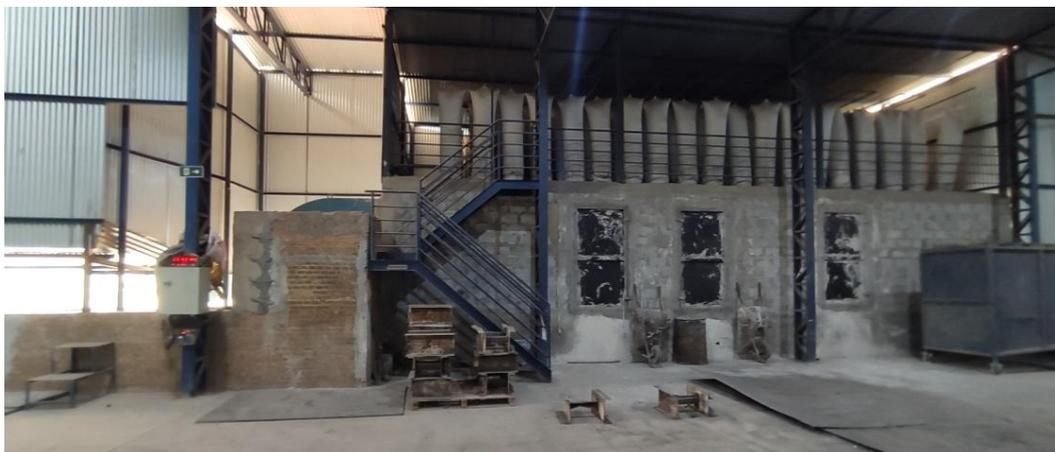
**Figura 21.** Sistema de Filtro de manga novo (atende forno 3)
