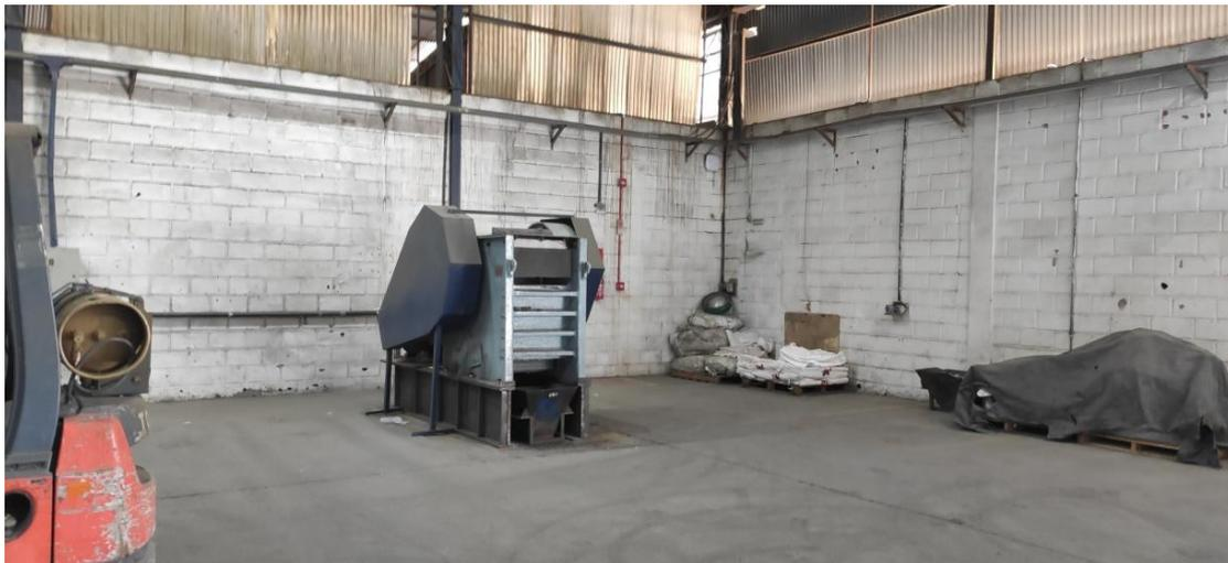
**Figura 7.** Equipamento Britador 2
