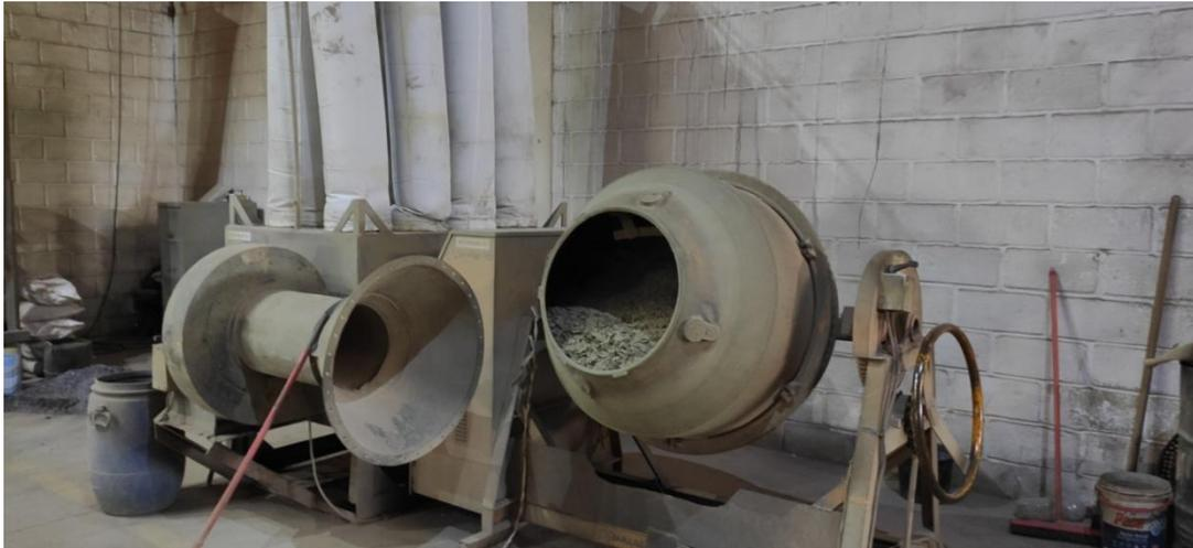
**Figura 4.** Betoneira utilizada para mistura das matérias-primas, com filtro de manga acoplado.
