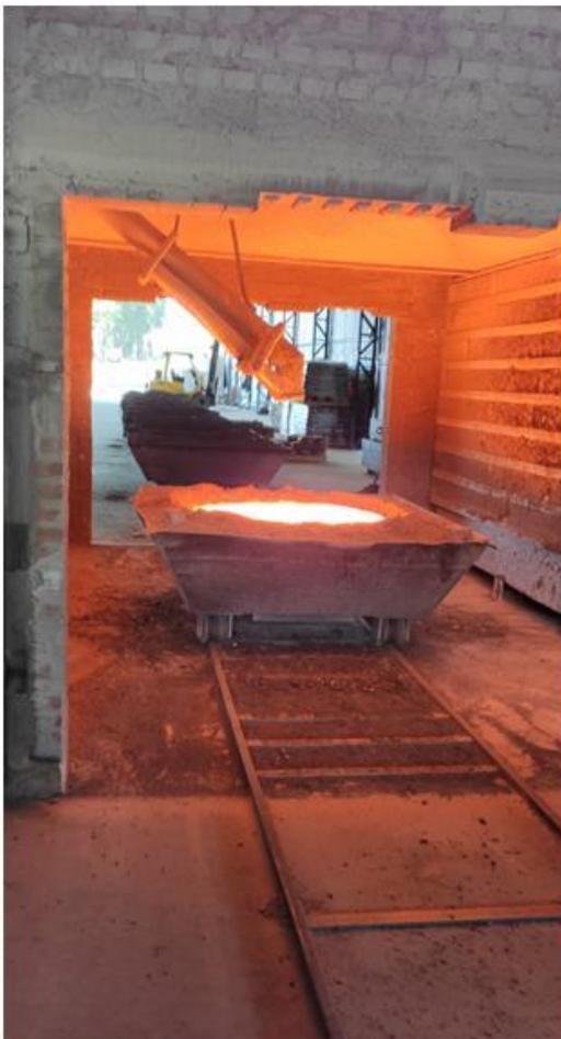
**Figura 11.** Saída da forma após fusão
