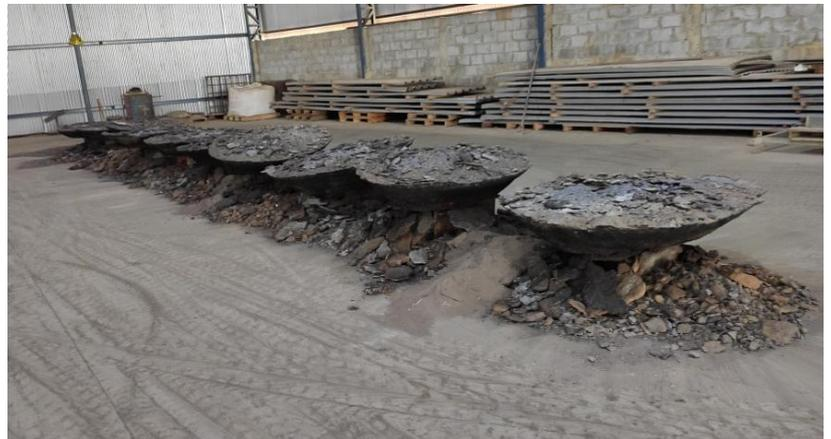
**Figura 12.** Ligas desmoldadas em resfriamento ambiente para separação de escória e produto final (liga metálica)
