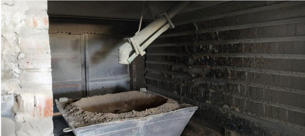
**Figura 10.** Abastecimento da mistura nas formas de fusão
