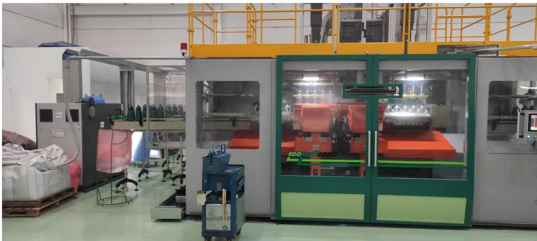
Figura 4. Linha 1 de fabricação da ampliação (moldagem de termoplásticos).
