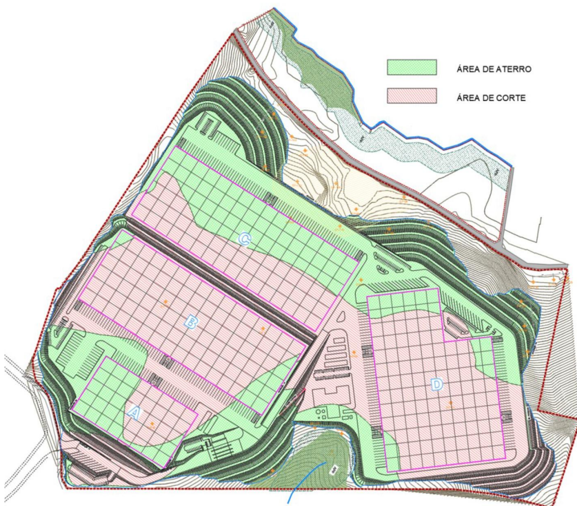
Figura 5. Projeto de terraplanagem do empreendimento.
