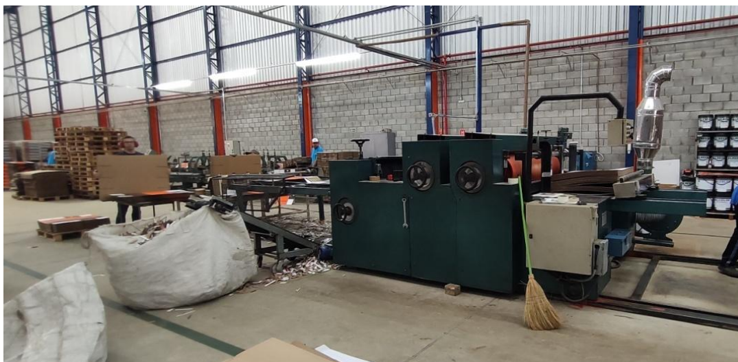
Figura 5 . Máquina de impressão/pintura e corte, com recolhimento de aparas e big-bags.
